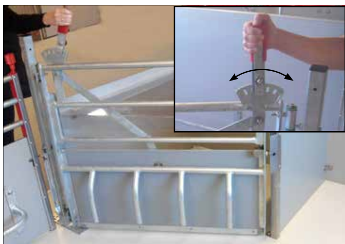
A alavanca é utilizada para regular a altura da placa que serve de barreira.
