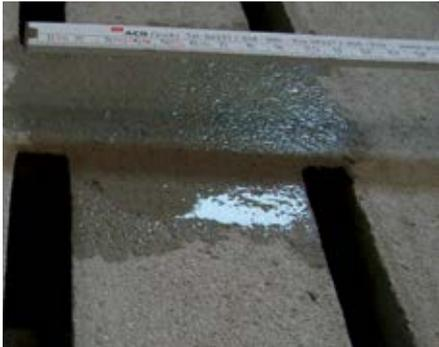
Piso de concreto sem tratamento - grande absorção de água
