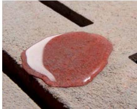
Piso de concreto tratado com ACO Funki Protect - não há absorção de água.
