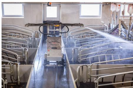
ProCleaner X100 pode ser programado para executar tão somente um programa de enxágue com vários tipos diferentes de lavagem. A máquina está conectada ao sistema de alta pressão existente na instalação mediante mangueiras de alta pressão standard; se requer um volume mínimo de água de 25 litros por minuto.
