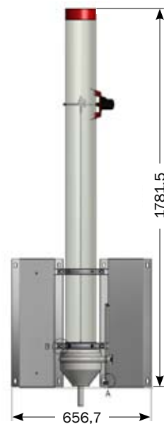
▲ Tolva con péndulo para la alimentación de lechones destetados
