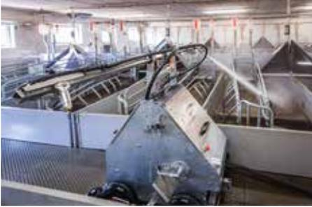
ProCleaner X100 es un robot de lavado potente, flexible y fiable para limpiar una gran diversidad de instalaciones porcinas. La máquina es simple en su diseño y construcción, pero alberga un robot de lavado de alta tecnología, capaz de hacer frente a los trabajos más exigentes.
