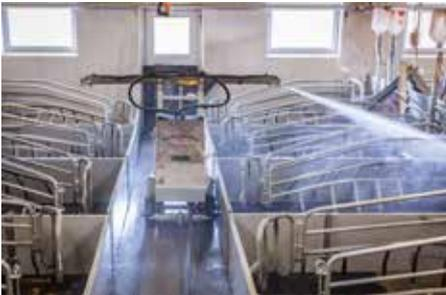
ProCleaner X100 puede programarse para ejecutar tan solo un programa de remojo como varios tipos diferentes de lavado. La máquina está conectada al sistema de alta presión existente en la instalación mediante mangueras de alta presión estándares.
