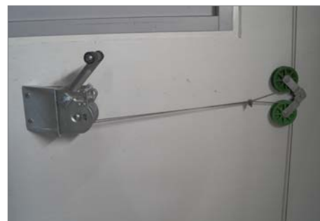
Polea manual con rueda de acero
